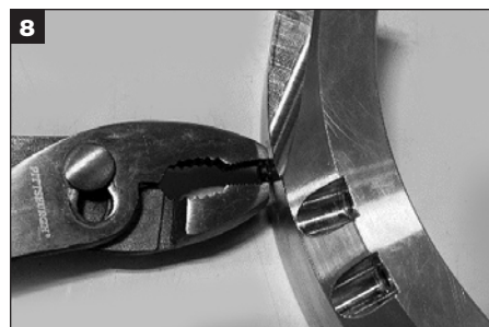
8 Irrota keskityspalat (6x) pyörivän pidikkeen ulkopinnalta.
